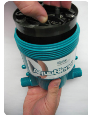
Paso 6. Coloque un pistón nuevo delicadamente en el cuerpo de la bomba y vuelva a colocar la tapa.
