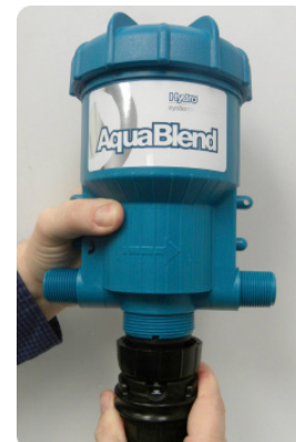
Paso 9. Vuelva a colocar el grupo del extremo inferior en el cuerpo de la bomba.
