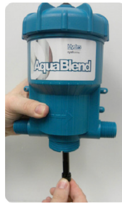
Paso 8. Gire el eje de 90° para bloquearlo en su alojamiento. Tire delicadamente hacia abajo para asegurarse de que el eje esté bloqueado.
