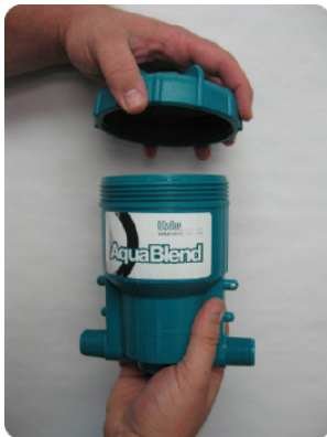
Paso 4. Sujete firmemente la unidad y desenrosque la tapa. Si la tapa está muy apretada, use una llave tubular de 1" (25mm) para aflojarla.
