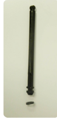
Paso 3. Extraiga la junta del eje e instale una nueva. Si la superficie de sellado del eje esta dañada, sustituya el eje.
